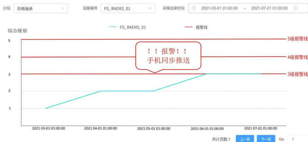
2021年6月触碰3级报警线(手机同步收到报警推送)。
