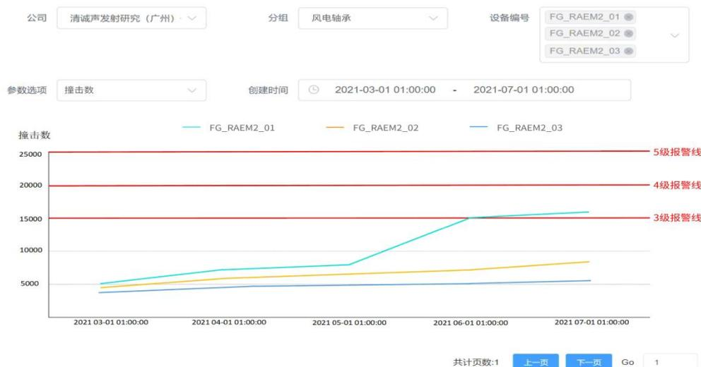
**图 2：**该风电机组轴承监测中，1 号通道每个月对应综合级别分别为：1，2，2，3，3
