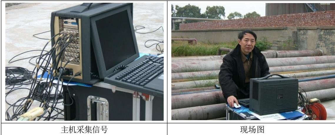
4) 特油公司特一联合站储罐声波（声发射）在线检测
