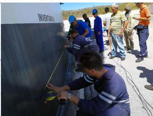
罐号 TK-56（2012 年投入使用），直径 74 米，设计液面高度 10.8 米，材质 A516-Gr70
