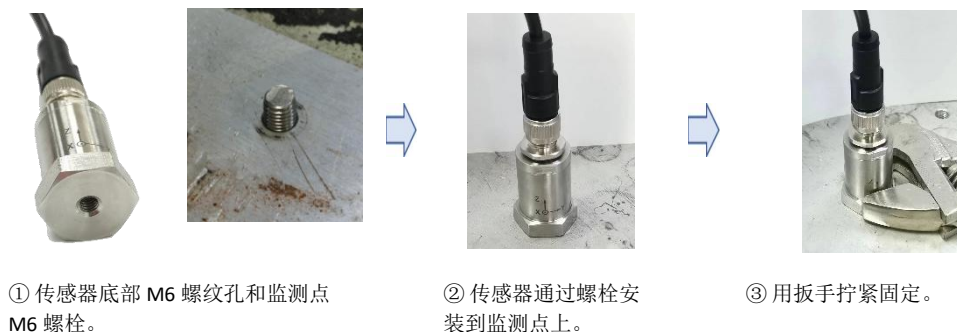
图 2-1 螺柱安装示意图
