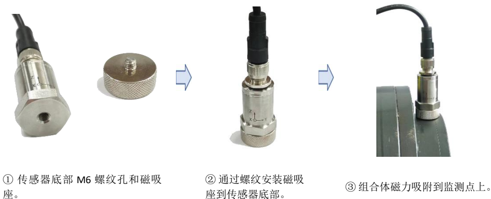
图 2-3 磁吸安装示意图
