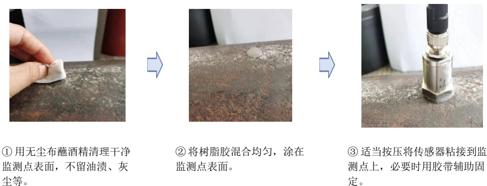
图 2-2 粘接安装示意图
