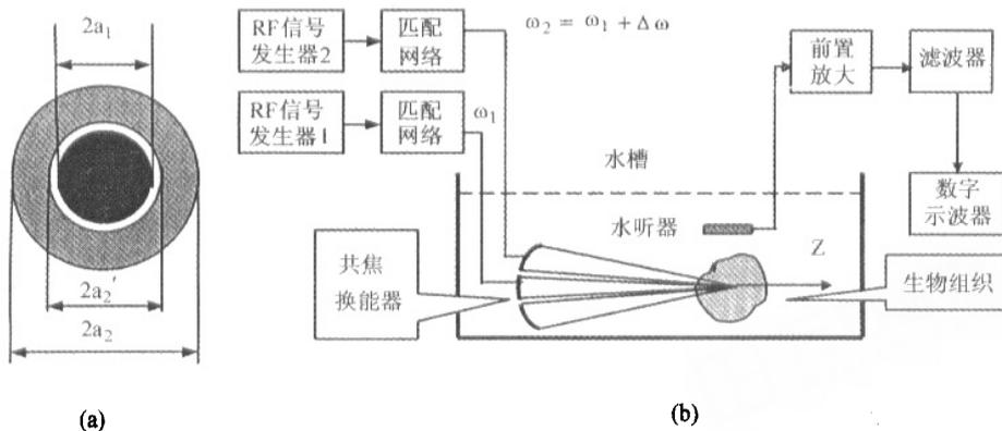
图 2 共焦换能器 (a) 和 USAE 信号产生及测量原理框图 (b)
