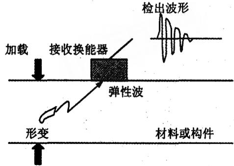
图 1 声发射法无损检测材料示意图
