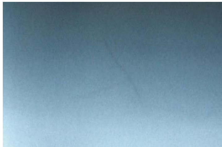
图 5 声发射源部位 \gamma 射线复验检测效果
