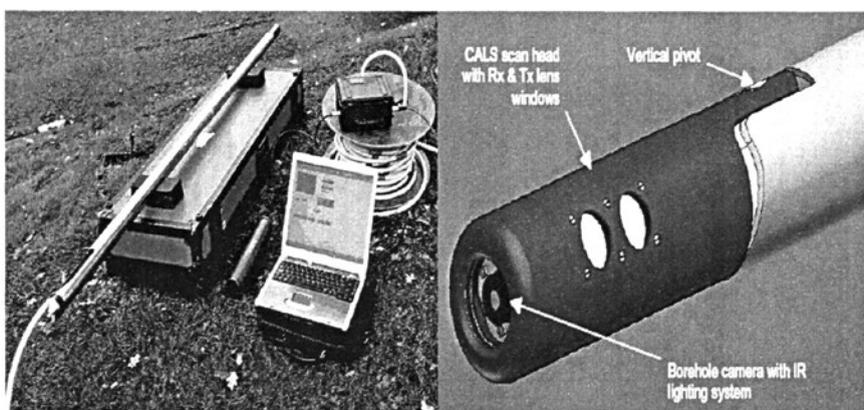
图 2-6 C-ALS 激光空区探测系统
